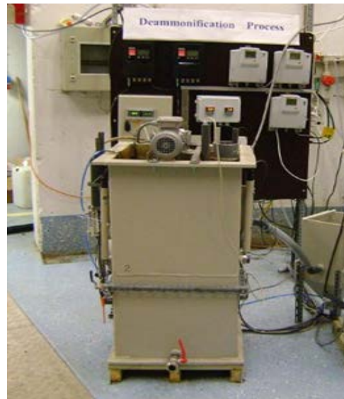
Anammox pilot scale reactor (Hammarby Sjöstadverk, Sweden)
